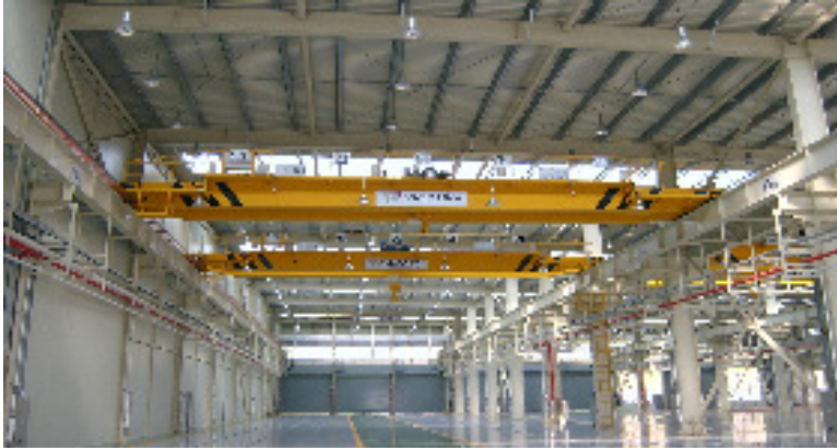
Overhead Cranes: • 2×5MT, 2×10MT • 3×20MT • 1×30MT • 1×30/30MT
